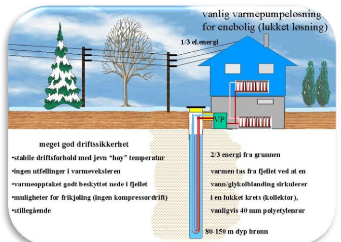
Eksempel på varmepumpeoppløysing – grunnvarme kjelde: www.ngu.no
